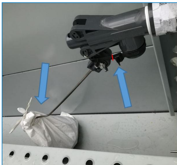
Fissaggio e avvolgimento della palla galleggiante
