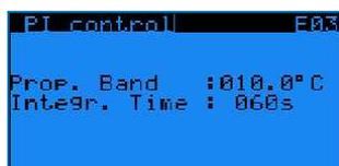
Paramètres PI : ces paramètres déterminent la vitesse de réaction de l'appareil aux changements de température de sortie du fluide.
