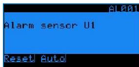
La sonde de température de sortie du fluide (sur l'entrée U1) est défectueuse.
