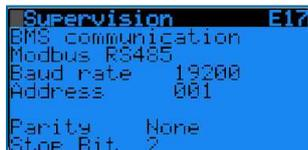
Sélectionnez le protocole de communication : Modbus RS485, Modbus IP, Carel RS485, LON, BacNet IP ou BacNet MSTP. Le cas échéant, définissez la vitesse de communication et l'adresse du réseau. Voir section 6 : communication GTB.
