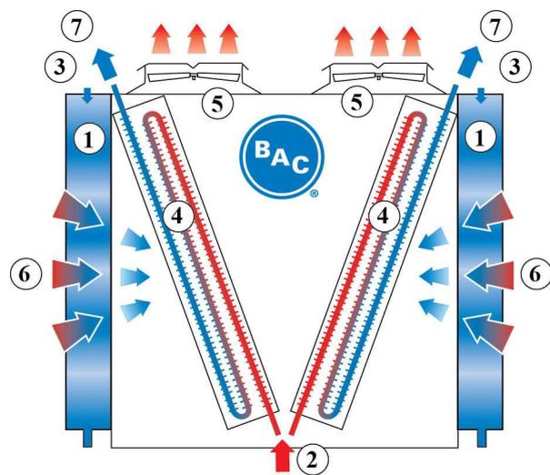
Le PLC régule la vitesse de ventilation en fonction de la température de sortie de fluide actuelle et selon le point de consigne standard ou de refroidissement naturel, assurant le plus bas niveau de consommation électrique et de bruit.
