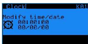
Réglage de l'heure et de la date correctes. Format de l'heure : HH:MM:SS - Format de la date : JJ/MM/AA.
