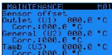
Programmation d'une compensation des sondes (« **Correction mesures** : ») pour corriger les valeurs de température affichées de la sonde de température de sortie du fluide (« **Outlet (U1)** ») et de la sonde de température ambiante (« **Tamb (U3)** »).
