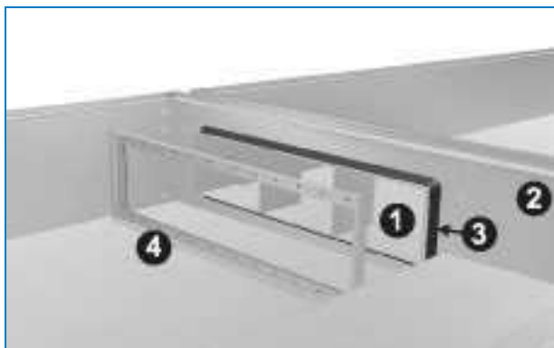
Установка опорного кольца
