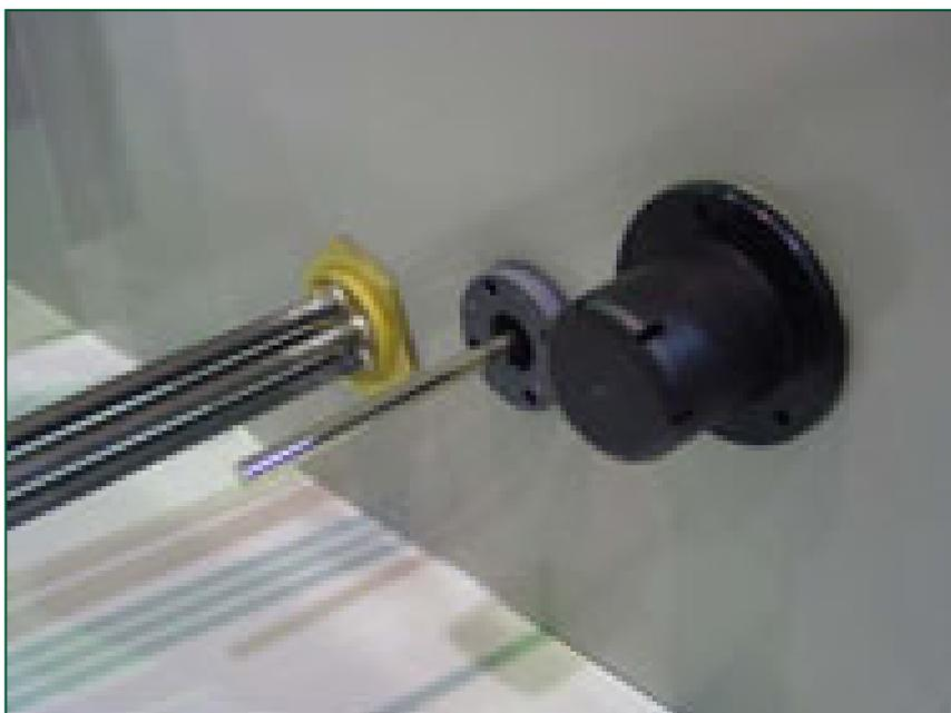
Unsere im Werk eingebauten Heizstäbe halten die Wassertemperatur bei 4 °C und fungieren als einfache und wirtschaftliche **Gefrierschutzmaßnahme für das Beckenwasser**. Das Heizungspaket beinhaltet die **Heizstäbe**, einen **Thermostat** sowie einen **Wassermangelschalter** zum Schutz der Heizstäbe bei zu geringem Wasserstand. Die elektrischen Standardheizstäbe sind für Umgebungstemperaturen bis 18° C geeignet.
