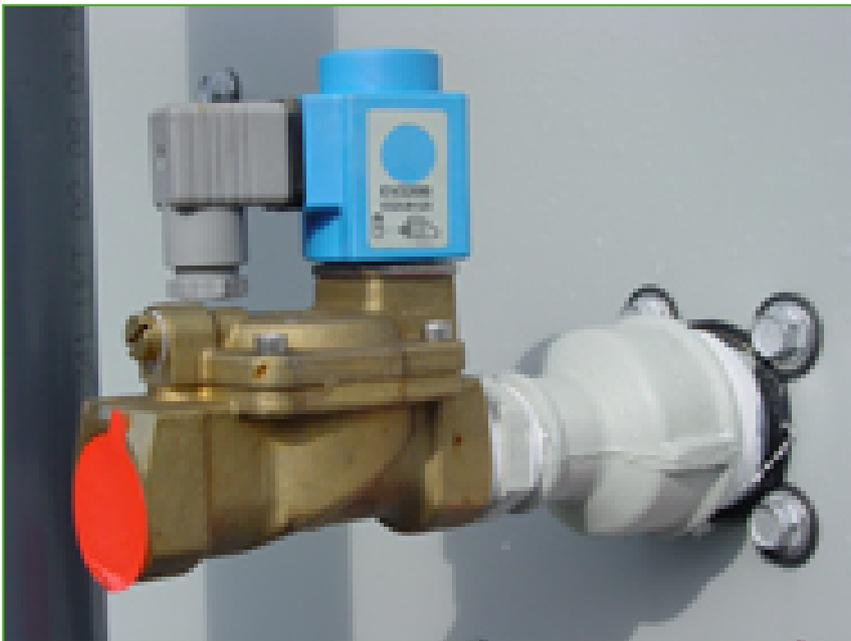
Wenn Sie eine **genauere Wasserstandsregelung** benötigen, sollten Sie das mechanische Standard-Frischwasserventil durch eine elektrische Wasserstandsregelung ersetzen.
