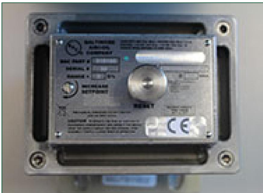
Der Schalter **erkennt eine übermäßige Vibration des Lüfterantriebs**, die durch eine Vereisung des Lüfters oder einen mechanischen Defekt verursacht wird. Auch wenn er im Werk montiert wird, wird der Schaltpunkt während der Installation und Inbetriebnahme vor Ort eingestellt.
