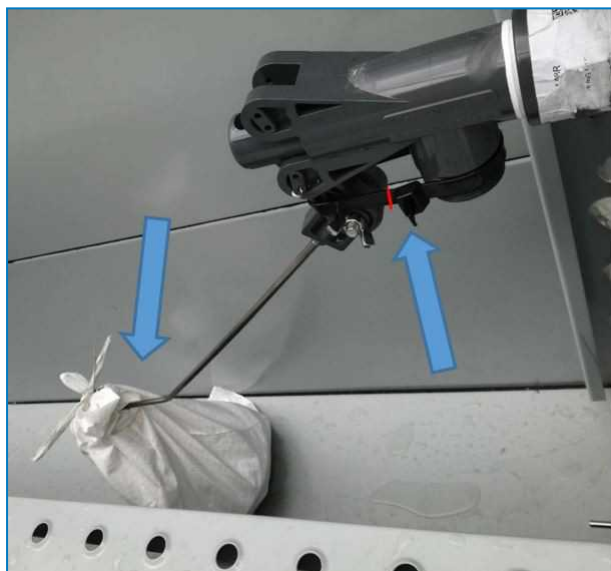
Bevestiging en inwikkeling van de vlotterbal
