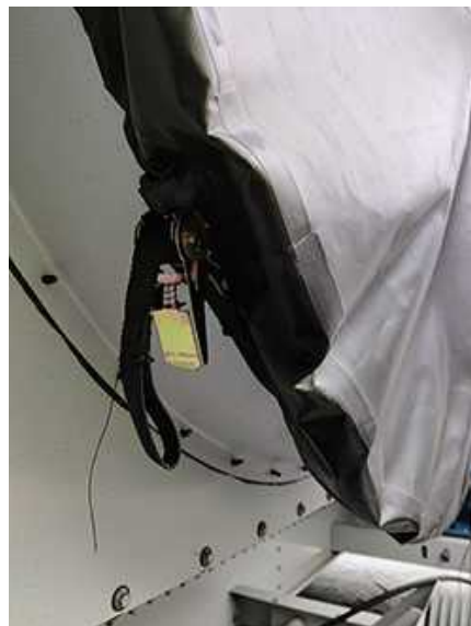
Stringere la cinghia per fissare il coperchio
