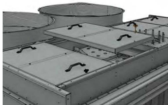
Se for aceder ao recipiente de água quente pela primeira vez, retire o respetivo retentor de transporte. Descarte os retentores de transporte dos recipientes de água quente.
